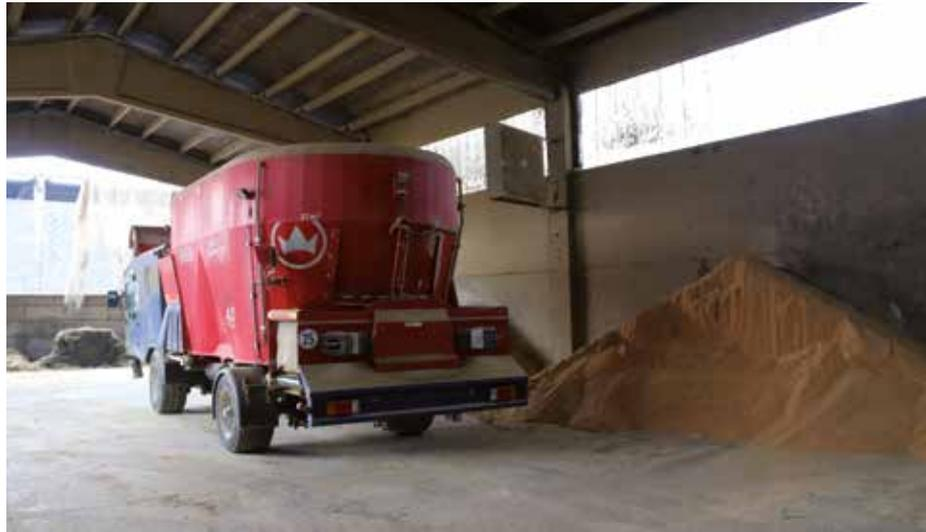
Il carro unifeed da 27 metri cubi di portata utilizzato in azienda. Grazie alla sua velocità di miscelazione – sottolineano i fratelli Riccò – è stata risparmiata una mezza unità di manodopera
